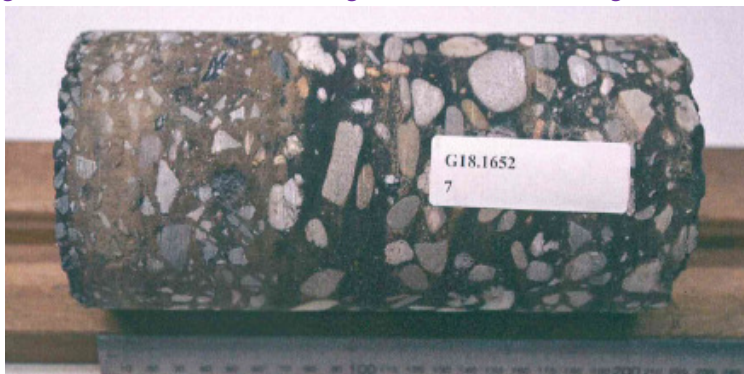
Figuur 5-3: Er zijn 67 asfaltboringen gedaan waarbij geen teerhoudende vervuilingen zijn aangetroffen.
