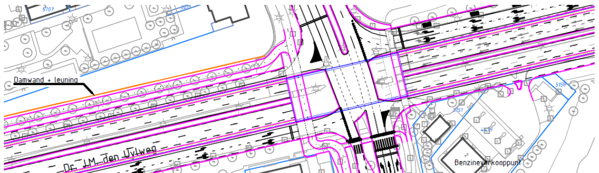
Figuur 4-3: In het schetsontwerp van de Verkenning is het noodzakelijk om de weg 3-4m naar de woningen te verschuiven en de bestaande bomenrij aan de noordzijde van de Den Uylweg te kappen.
